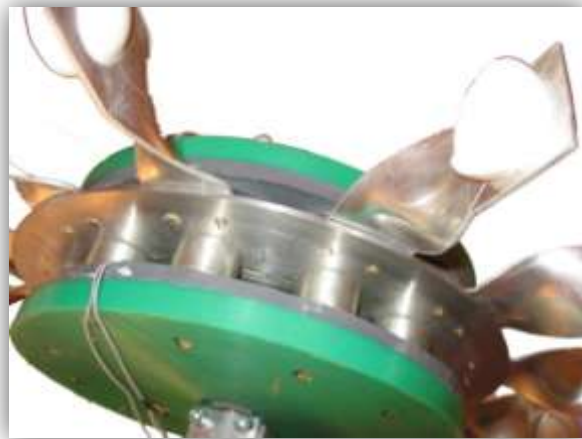
Abb. 5: Pelton-Turbine: Magnete auf der rotierenden Alu-Scheibe, Spulen in fest montierten grünen Kunststoffscheiben
