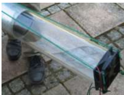
Abb. 3: Axiallüfter am Fallrohr
